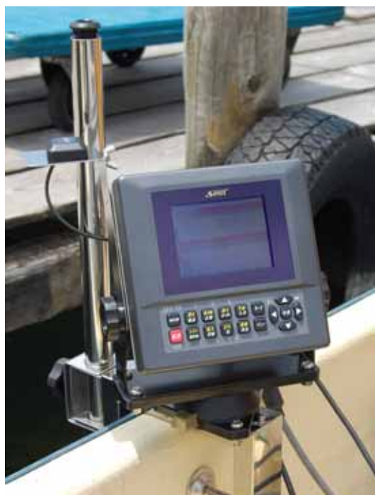
SSV-35 をレンタルボートに設置した画像
